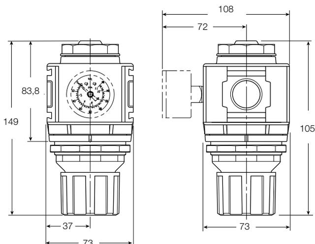
**REMARQUE :** un trou de 60 mm est nécessaire pour le montage sur panneau avec écrou.
