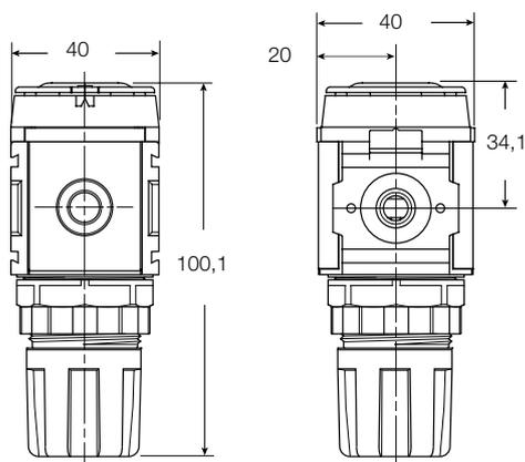
**REMARQUE :** un trou de 30 mm est nécessaire pour le montage sur panneau avec écrou.
