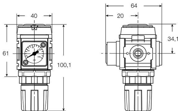
**REMARQUE :** un trou de 30 mm est nécessaire pour le montage sur panneau avec écrou.
