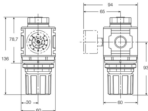
**REMARQUE :** un trou de 47 mm est nécessaire pour le montage sur panneau avec écrou.
