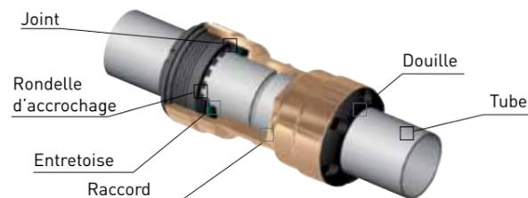
Les raccords de jonction Ø 22 et Ø 28 se connectent instantanément au tube Transair® acier inoxydable. Il suffit simplement d'enfoncer le tube dans le raccord jusqu'en butée. La rondelle d'accrochage du raccord est alors armée et la connexion est sécurisée.
