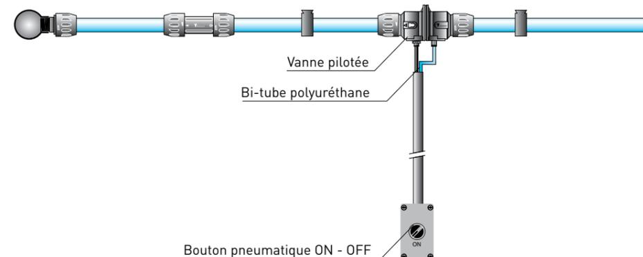
Montée par simple connexion instantanée sur le tube aluminium, la vanne pilotée Transair® Ø 40 permet d'effectuer depuis le sol, rapidement et en toute sécurité, l'ouverture et la fermeture de l'alimentation du réseau.
