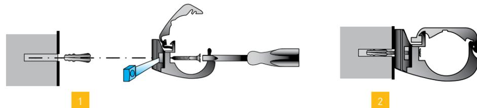
1 - Enlever l'écrou situé à la base du clip à l'aide d'un tournevis. Mettre en place la vis en la passant par l'intérieur du clip.
