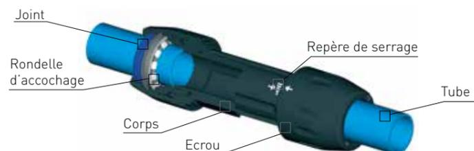
Les raccords de jonction Ø 16,5, Ø 25 et Ø 40 sont prêts à l'emploi et se connectent instantanément au tube Transair® aluminium. Il suffit simplement d'insérer le tube dans
