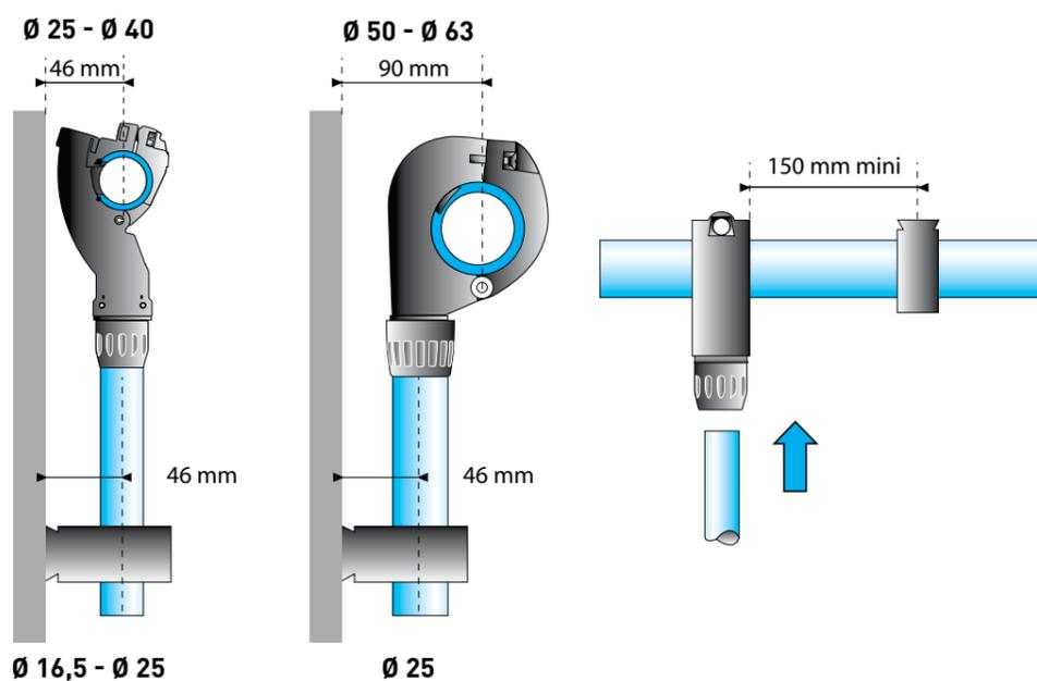
Pour les brides de dérivation Transair® Ø 25 et Ø 40, la distance séparant l'entraxe du tube et la cloison est égale à la distance séparant l'entraxe de la dérivation et la cloison, soit 46 mm.
