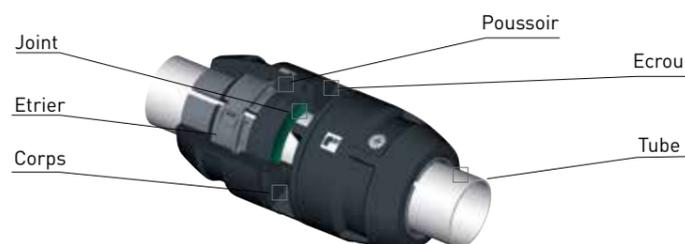
Les raccords de jonction Ø 42 et Ø 60 se connectent au tube Transair® acier inoxydable au moyen d'un double étrier. Celui-ci rend le raccord et le tube solidaires. La connexion s'effectue par simple vissage de l'écrou.
