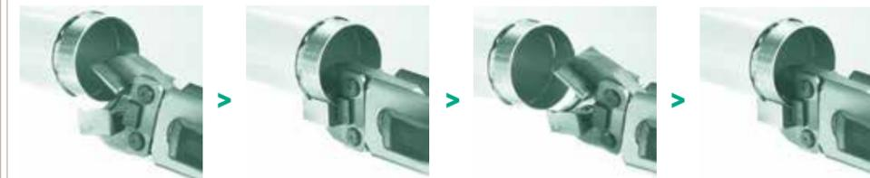
Ouvrir manuellement les 2 mâchoires de la pince. Insérer le tube dans la pince jusqu'en butée.
