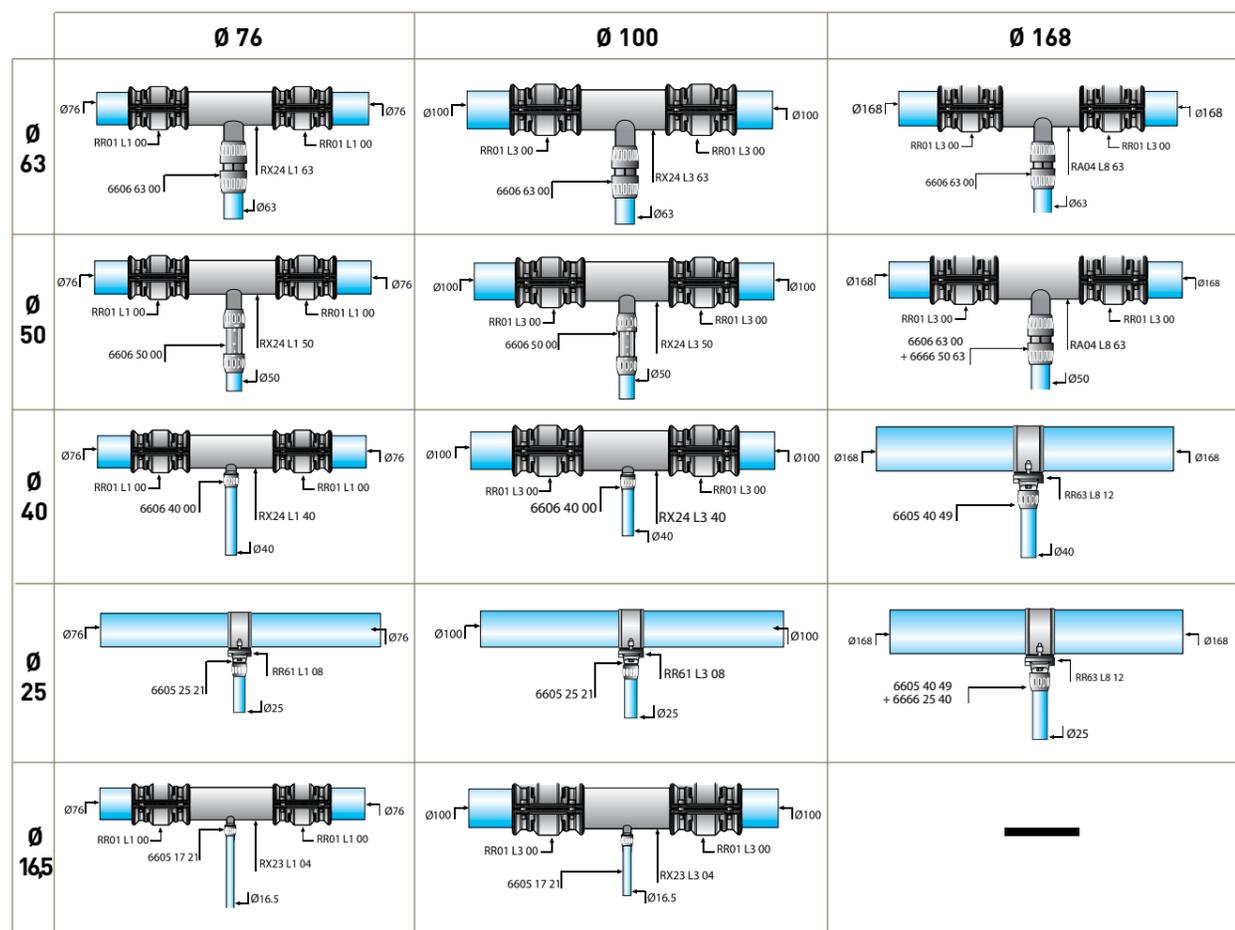
Distance minimale entraxe tube-cloison à partir d'un té Ø 76 - Ø 100 - Ø 168
