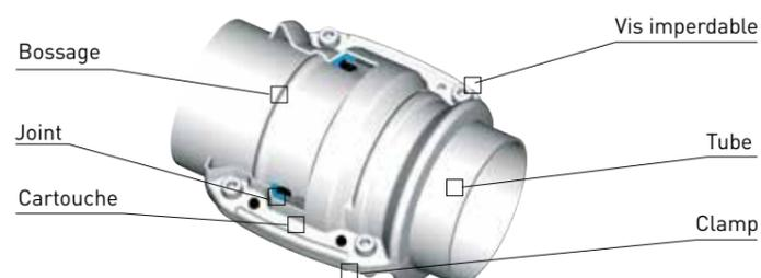
Les raccords de jonction Ø 76 et Ø 100 se connectent immédiatement au tube Transair® acier inoxydable. Il suffit simplement de positionner les tubes à raccorder dans la cartouche Transair® (élément permettant de réaliser l'étanchéité) puis de refermer le clamp Transair® (élément permettant de sécuriser la connexion) et enfin de réaliser le serrage des 4 vis.
