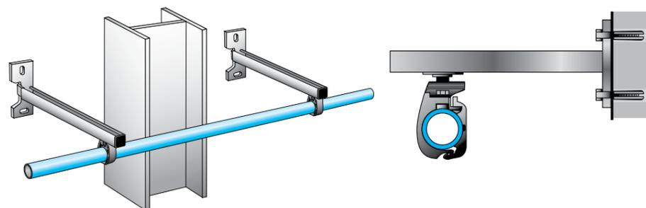
Les consoles modulables Transair® permettent de déporter les réseaux et de contourner des obstacles. Elles se composent d'un rail profilé 6699 01 01, d'un ensemble d'accessoires de fixation 6699 01 02.
