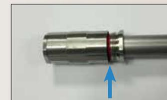
Démontage : 2. Mettre la bague de démontage rouge sur le tube et revisser l'écrou sur le raccord.
