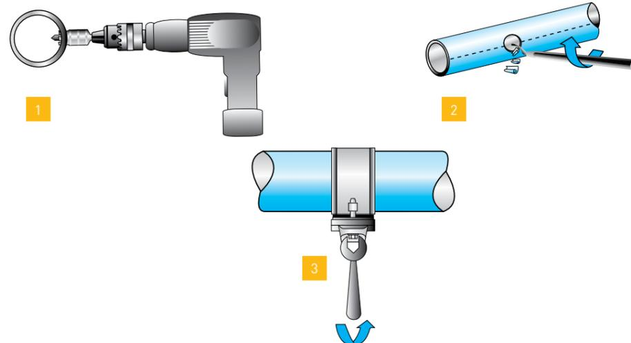
1 - Percer le tube aluminium à l'endroit souhaité à l'aide de l'outil de perçage adapté : • Ø 76 - Ø 100 : taraudage 1" > outil de perçage **EW09 00 30**
