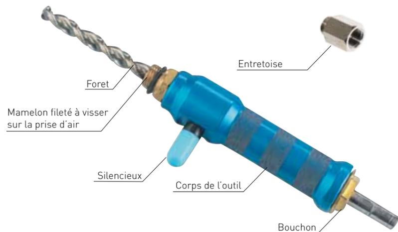
Utiliser l'outil de perçage sous pression EA98 06 00 pour installer une bride pour prise d'air sous pression. Celui-ci s'adapte facilement sur toute perceuse standard.
