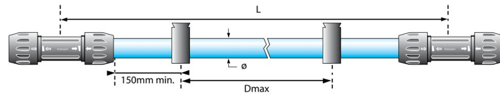
Le clip de fixation Transair® est le composant de base dans la fixation d'un réseau Transair® en aluminium en Ø 16,5 - Ø 25 - Ø 40 - Ø 50 - Ø 63. Il est important de l'utiliser car il permet de laisser libre cours aux phénomènes de dilatation et de contraction.
