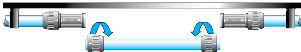
Dévisser les écrous situés du côté du tube à déplacer, les faire glisser le long de ce même tube. Puis ôter le tube.
