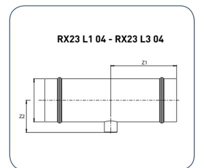
■ Pour répondre aux contraintes des applications air comprimé et vide en **environnement sévère** (industrie agroalimentaire, pharmaceutique ou laboratoires), Transair® propose désormais une gamme complète de **descentes Ø22 mm en acier inoxydable 316L**.
