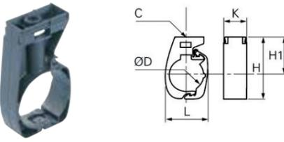
**CLIP DE FIXATION POUR TUBE RIGIDE ALUMINIUM**
