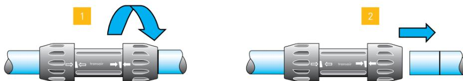
Il suffit simplement d'enfoncer le tube dans le raccord jusqu'au témoin de connexion. Pour déconnecter, dévisser l'écrou d'un demi-tour et retirer le tube.
