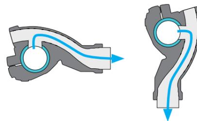
Les brides de dérivation "pose rapide" nouvelle génération permettent de réaliser des descentes rigides ou souples, verticales ou déportées horizontalement.
