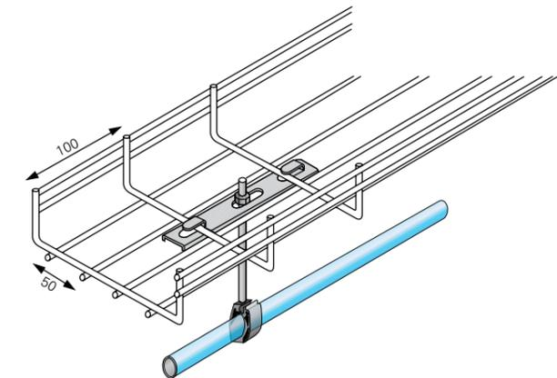
Utiliser la fixation sous chemin de câble fil 6699 10 30. L'ouverture oblongue 10x30 peut accepter le passage de tige filetée jusqu'en M10.
