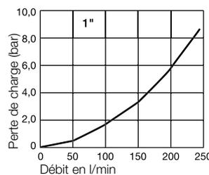
**Note:** La perte de charge montrée doit être additionnée à la pression d'ouverture pour obtenir la perte de charge totale.
