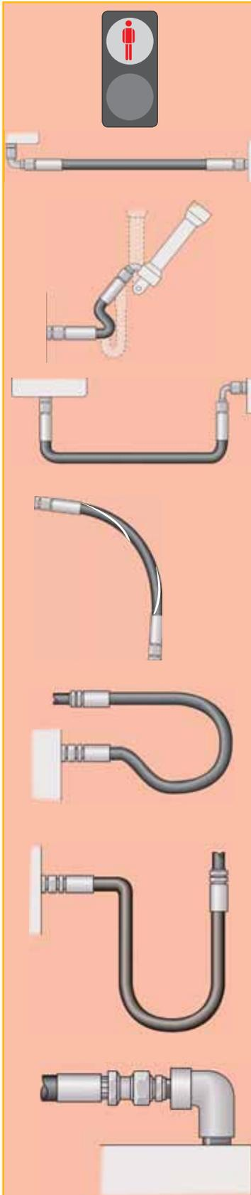
L'installation d'une tuyauterie flexible et l'environnement dans lequel elle fonctionne ont une influence directe sur sa durée de service. Les figures suivantes indiquent la façon correcte d'installer une tuyauterie flexible afin d'en assurer un fonctionnement sûr et de longue durée.
