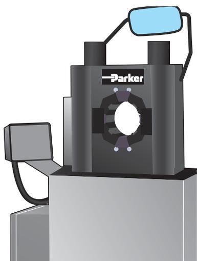
Pour sertir les embouts ParLock série V4 une machine à sertir d'une puissance de 320 tonnes minimum est recommandée. Min. 350 tonnes pour la série V6.
