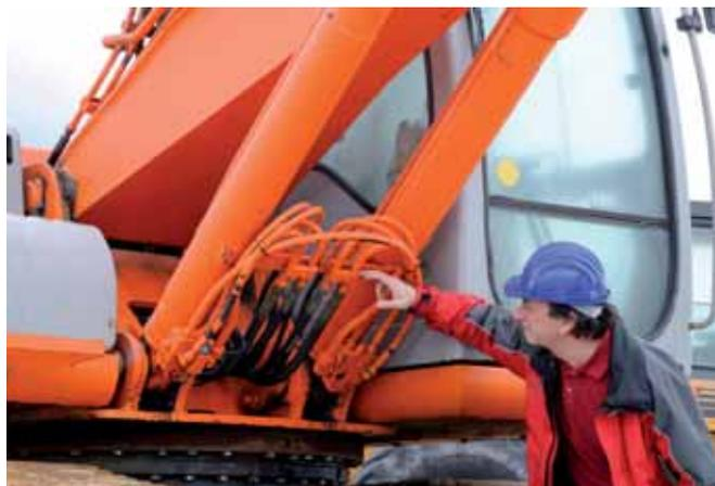
Le programme de maintenance proactive inclut une planification des visites d'inspection et du remplacement préventif des tuyauteries flexibles, dans le cas où une tuyauterie présente des signes de défaillance probable:
